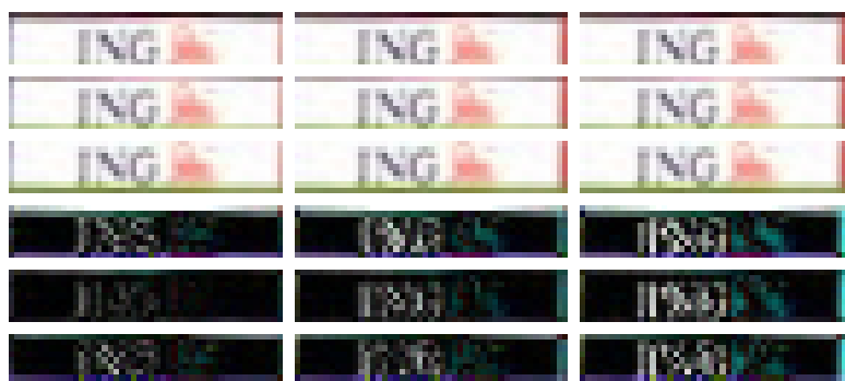
Figuur 6: Boven: In deze figuur zijn de 9 samples, die uit een frame zijn geëxtraheerd, afgebeeld. Onder: De absolute differences van de samples en het sample uit het vorige frame. Het sample links-midden is in dit geval de beste match.
