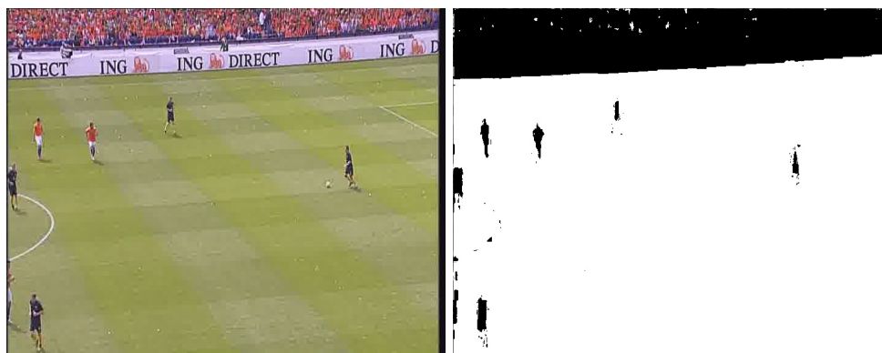
Figuur 1: Iedere pixel is geclassificeerd als zijnde graspixel ( hoog ), danwel niet graspixel ( laag ).
